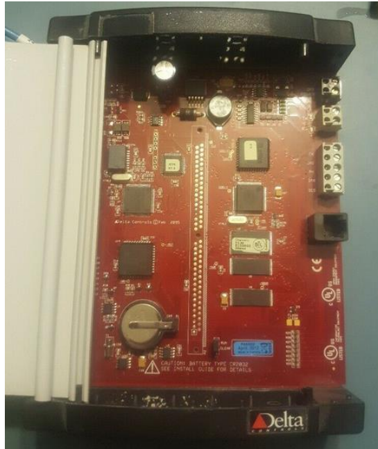
شکل ۵-۲۱: طرح بندی الکترونیکی بُرد ماژول کنترل‌کنندهٔ سخت‌افزاری DSM (Delta, 2013)
