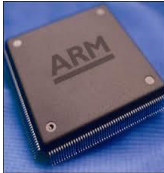
شکل ۷-۴: نمونه‌ای از میکروکنترلرهای ARM (بهرام‌پور، سایت پاورجام)
