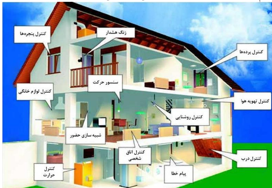
شکل ۲-۲: بخش‌های مختلف سیستم یکپارچه در مدیریت ساختمان هوشمند (بانسی، ۲۰۱۵)
